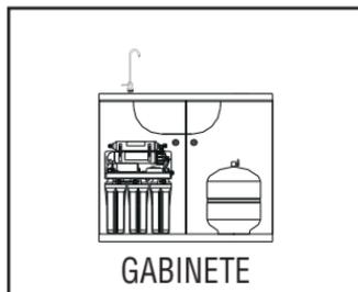
**Nota:** Todos los componentes y conexiones deben estar localizadas en un área que no estén expuestas a bajas temperaturas ni rayos directos del sol.
